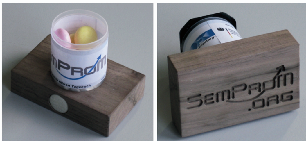
Bild 3: Die „smarte Medikamentendose“ besteht aus einem hölzernen Träger (mit MDS D160 Transponder und Projektlogo auf der Unterseite) und einer mit Medikamenten gefüllten Plastikdose
